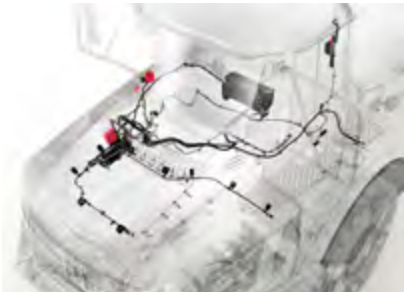
Yangın söndürme sistemi
